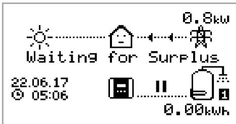
**eddi** wartet auf überschüssige Energie aus dem Haus-Energieerzeugungssystem. Das Haus-Symbol mittig in der Abbildung zeigt den Energieverbrauch des Hauses kommend aus dem Stromnetz (0#%W hier).
