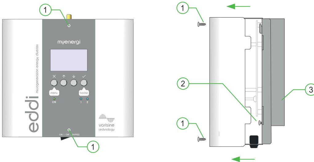
2. Nehmen Sie die Montageplatte (3) vom **eddi** ab, indem Sie die 2 Sicherungsschrauben (2) lösen.
