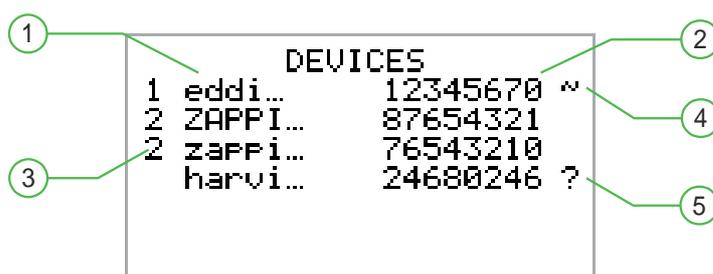
Die Seriennummer (2) von jedem Gerät (1) ist rechts daneben abgebildet. Die Priorität (3) wird links vor jedem Laststeuergerät angezeigt. Die 1 steht für höchste Priorität. Wenn zwei oder mehrere Geräte die gleiche Priorität haben, wird die vorhandene Überschuss-energie gleichmäßig unter den Geräten aufgeteilt.
