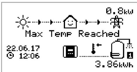
Die max. Temperatur für den Wasserspeicher ist erreicht. Es werden keine Pfeile oder Leistungsangaben für das Heizgerät angezeigt. Das Thermometersymbol ist sichtbar. Da **eddi** nun nicht mehr überschüssige Energie zum Heizgerät leitet, wird diese somit in das Netz exportiert (0&%W in diesem Beispiel). Wäre ein weiteres Heizungssystem angeschlossen, würde **eddi** nun auf dieses Umschalten.
