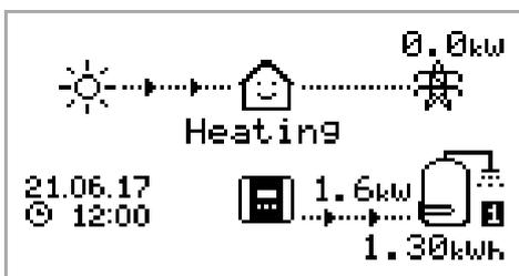
**eddi** leitet nun Strom zum Heizelement des Wasserspeichers. Das aktuell angesteuerte Heizelement wird durch das Symbol auf der rechten Seite angezeigt. Die kleine Zahl (in diesem Fall 1) entspricht der Nummer des Heizelements. Die aktuelle Leistung 1&6 %W wird zwischen dem **eddi**-Symbol und dem Heizgerät-Symbol angezeigt. Die gesamte überschüssige Energie, die dem Heizgerät heute zugeführt wurde, beträgt kumuliert 1&' %W(. Das Haus lächelt, weil kein Netzstrom verbraucht wird.
